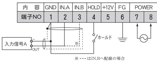
※入力信号のシールド線は端子①(GND)へ配線してください。
