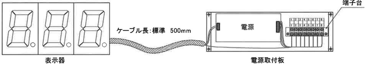
・ケーブル長は、標準 500mm で製作します。(ケーブル長変更の場合は別途指示。)
