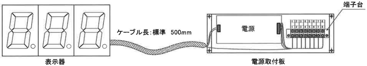
・ケーブル長は、標準 500mm で製作します。(ケーブル長変更の場合は別途指示。)
